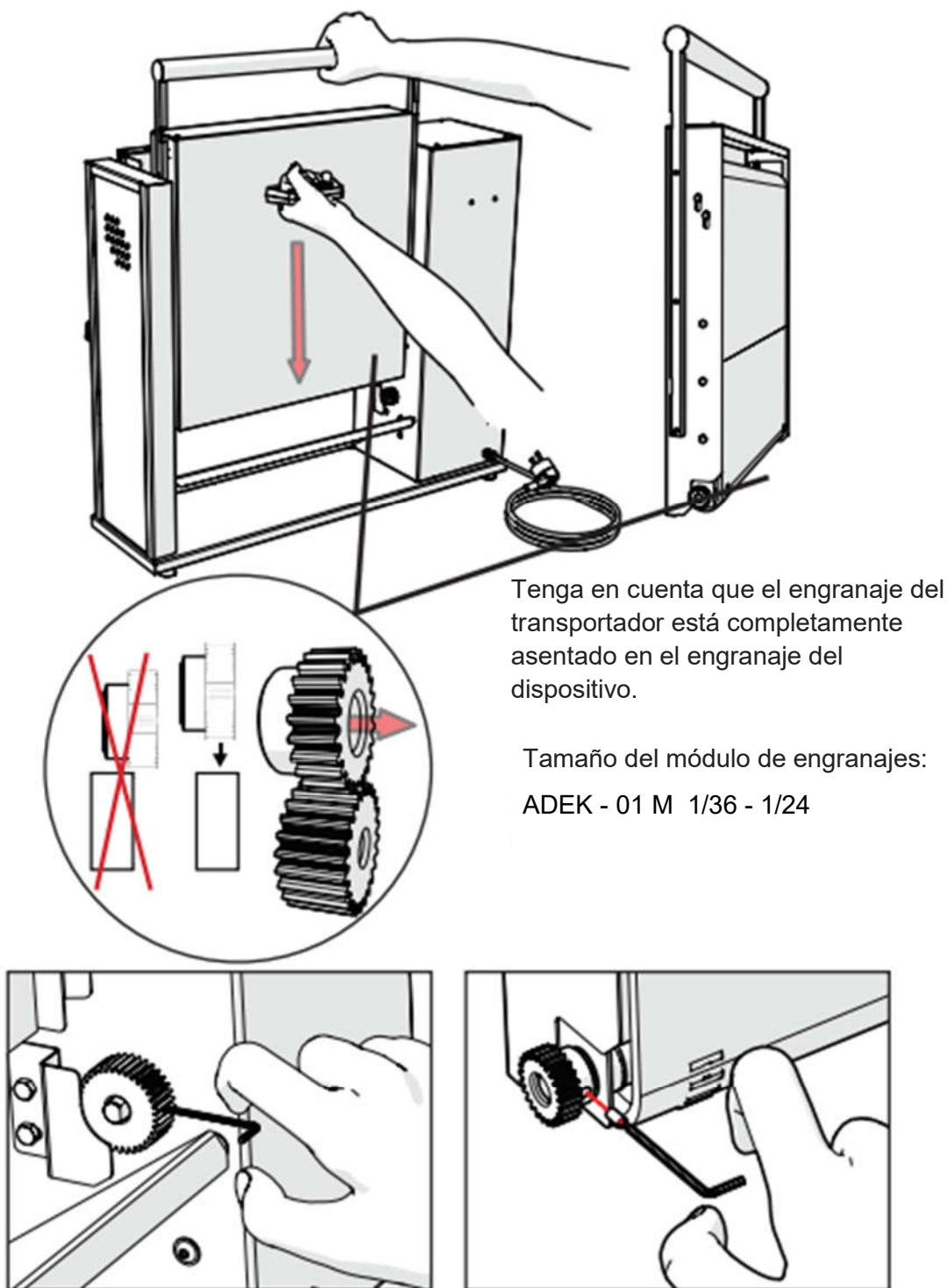
Al quitar los pernos de fijación del engranaje con la llave Allen, los engranajes pueden ser reemplazados.
